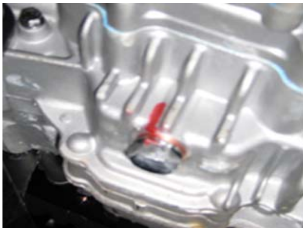
Výpustní šroub oleje ( spodní část motoru )
