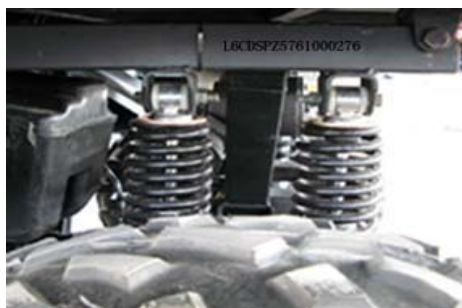
Umístění čísla VIN ( na rámu nad pravým zadním kolem)
