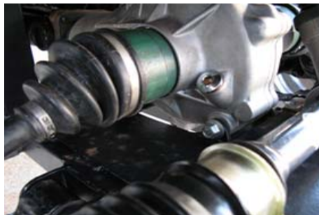
Přední omezovač rychlosti, kontrola oleje
