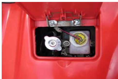
Zátky pro chladící a brzdové kapaliny
